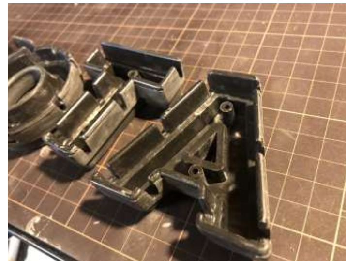
裏面の穴を使って、全体をプラモデルのように一つのパーツとして何らかの方法で接続することも可能
